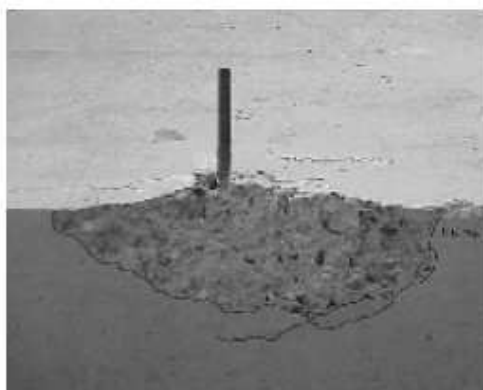
Rys. 2. Zniszczenie krawędzi betonu
