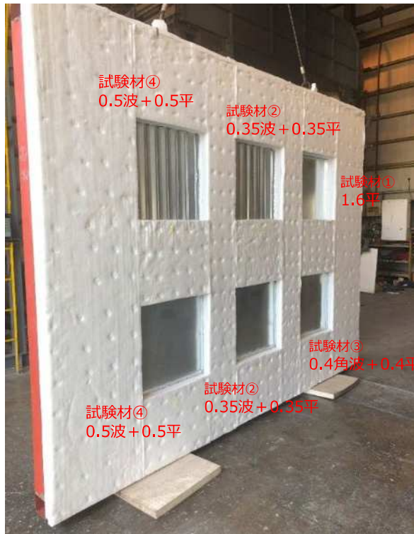
試験用サンプル扉 (火炎側)
