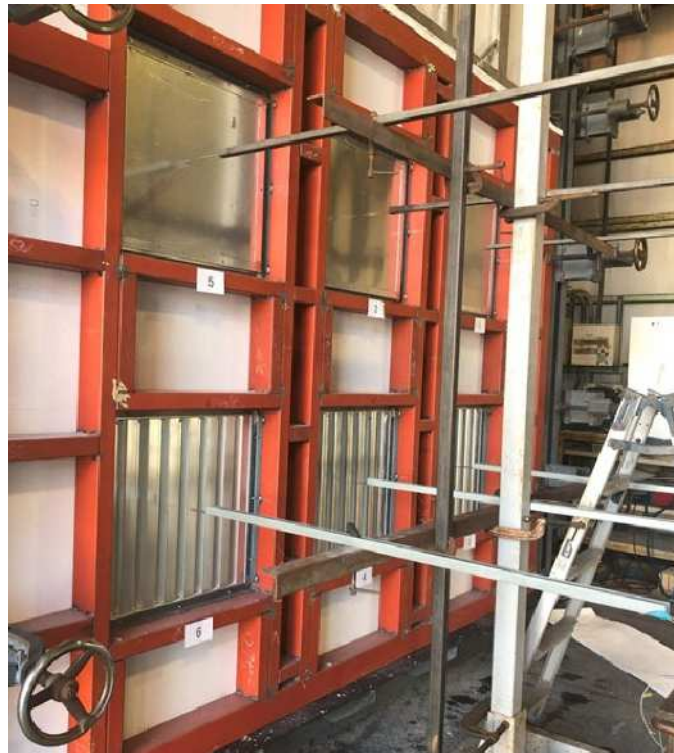
熱電対の設置状況 (非加熱面から1 cm、5 cm離れた位置)
