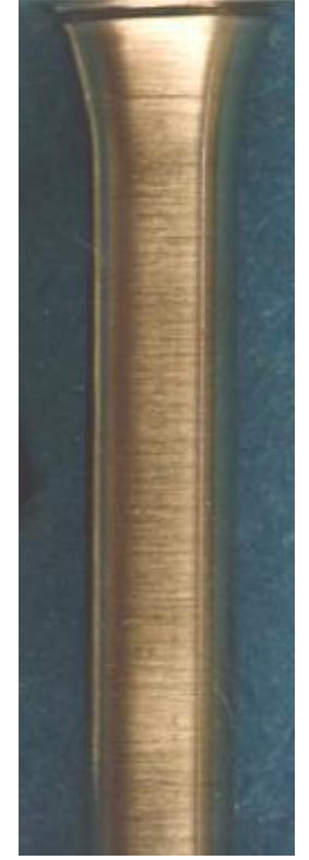
Yüksek Korozyon Dayanımlı Çelik (HCR) Yüksek seviyede molybdenum katkısı çürümeye karşı direnci ciddi oranda arttırmaktadır
