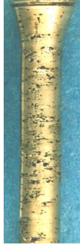
Paslanmaz Çelik Galvanize kaplı karbon çeliğine göre daha performanslı olmakla beraber yinede çürüme tipi korozyon görülebilir
