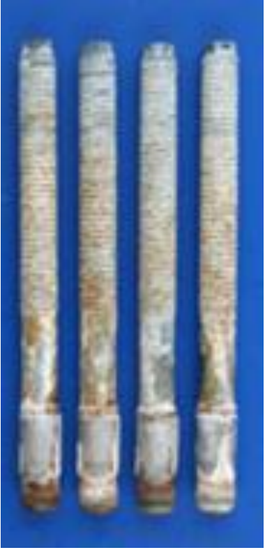
Galvanize Çelik Paslanma etkisi çok uzun sürmeden gözlenir
