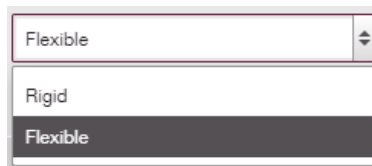
Figura 8. Opzioni di progettazione della piastra di base per la determinazione della distribuzione del carico agli ancoranti
